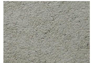
**Hydraulischer Feinputz Vollabrieb 0-1 mm**
